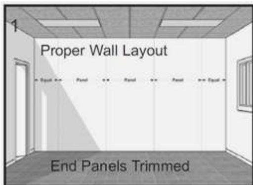
Para una apariencia equilibrada, establezca una línea central de área a cubrir e instale los perfiles de moldura por división y trabaje hacia las esquinas
