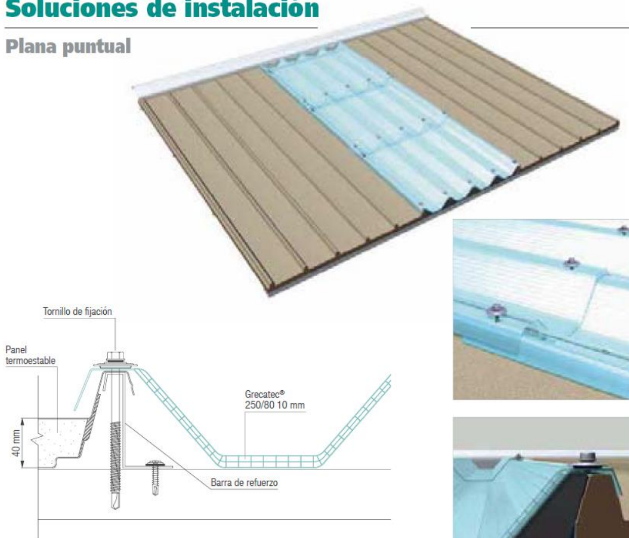
Detalle de fijación y solape lateral con Grecatec® 250/80 10 mm
